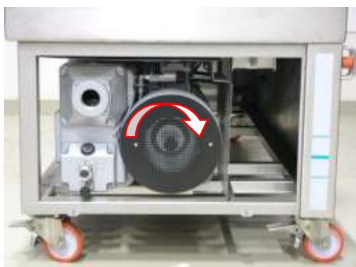
Afbeelding 12: Draairichting van motor voor vacuümpomp
