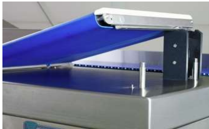
Abbildung 14: Den mitgelieferten Ständer dazu verwenden, das Förderband zum Zwecke der Reinigung in eine aufrechte Position zu bringen.
